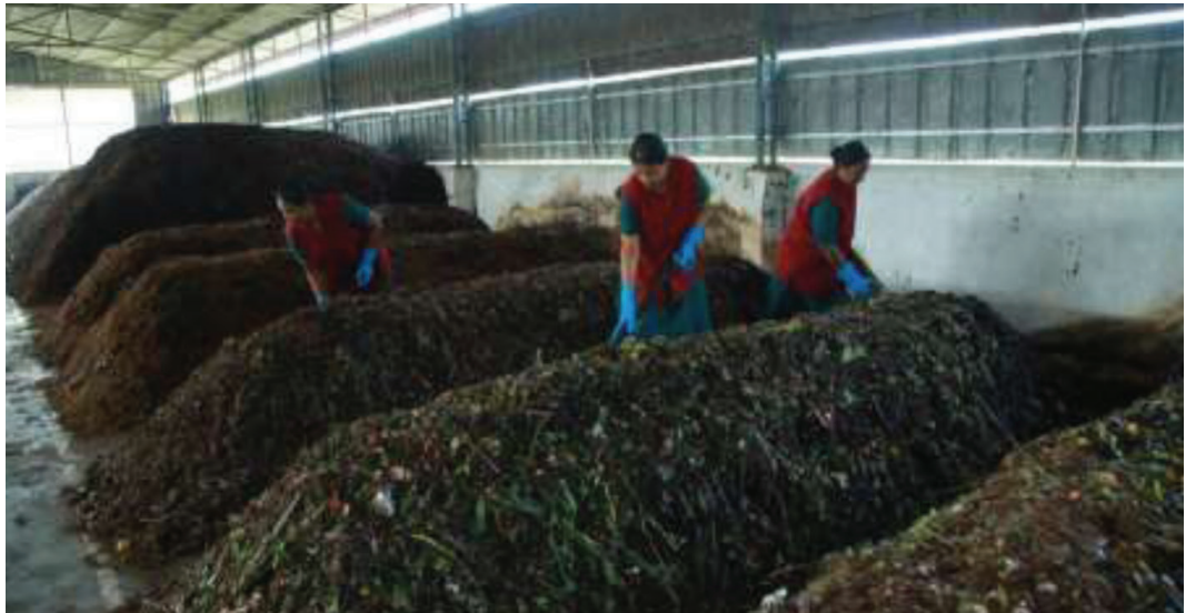
വായു സഞ്ചാരമുള്ള വലിയ അറകളിൽ കമ്പോസ്റ്റിംഗ് (Aerobic Bin Composting, Thumbboomuzhi Model)
